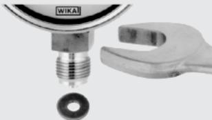
Kod cilindričnih navoja na brtvenoj površini moraju se upotrebljavati plosnate ili lećaste brtve, odn. WIKA profilne brtve ①. Kod koničnih navoja (npr. NPT navoja) brtvljenje se vrši u navojima ② uz pomoć prikladnog brtvenog materijala (EN 837-2).
