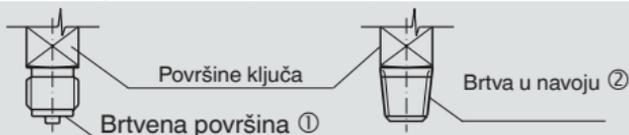
Pritezni moment ovisi o korištenoj brtvi. Kako biste mjerni instrument mogli usmjeriti da bi očitavanje bilo što lakše, postavite steznu spojnicu ili spojnu maticu.
