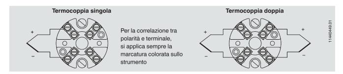
Per le connessioni elettriche del trasmettitore di temperatura integrato, vedere le corrispondenti schede tecniche o il manuale d'uso
