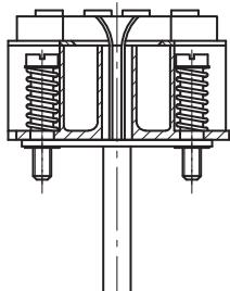
Elemento de medição com transmissor montado
