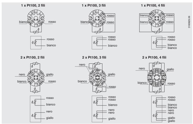
Per le connessioni elettriche del trasmettitore di temperatura integrato, vedere le corrispondenti schede tecniche o il manuale d'uso.
