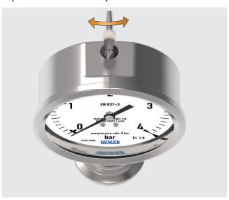
La regolazione del punto zero può essere effettuata con un cacciavite a punta piatta dopo la rimozione del tappo di tenuta sulla parte superiore della cassa. Campo di regolazione  $\pm 15^{\circ} \triangleq \pm 5,5\%$  dello span.
