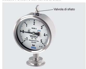
Il modello PG43SA-S con valvola di sfiato è stato appositamente ideato per la pulizia dall'esterno ("wash-down") con detergenti chimici particolarmente aggressivi in sistemi di pulizia dell'industria farmaceutica (p.e. impianti di lavaggio per il settore farmaceutico). Quando la valvola di sfiato è chiusa, lo strumento è ben protetto da influssi esterni (p.e. detergenti) grazie al grado di protezione IP68. Durante il funzionamento e la sterilizzazione
