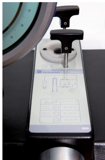
Схема управления прессовой части прибора CPB3800HP
